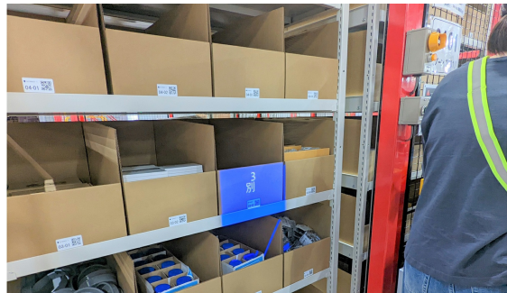
(左)入荷バース、(右)ピッキング位置と数を知らせるプロジェクションマッピング
