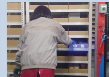
プロジェクションマッピングを利用した出庫作業
