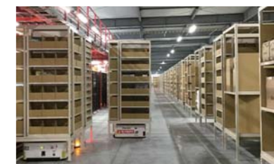
商品棚を運搬する自律搬送型ロボット (笠間ディストリビューションセンター)
