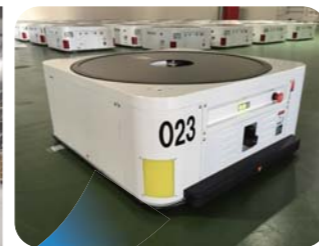
無人棚搬送システム
