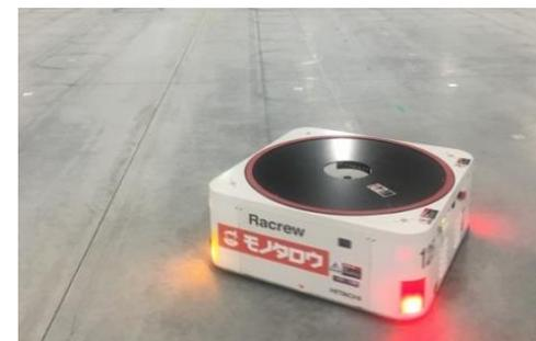
笠間DCで使用する自律搬送型ロボット(AGV)
