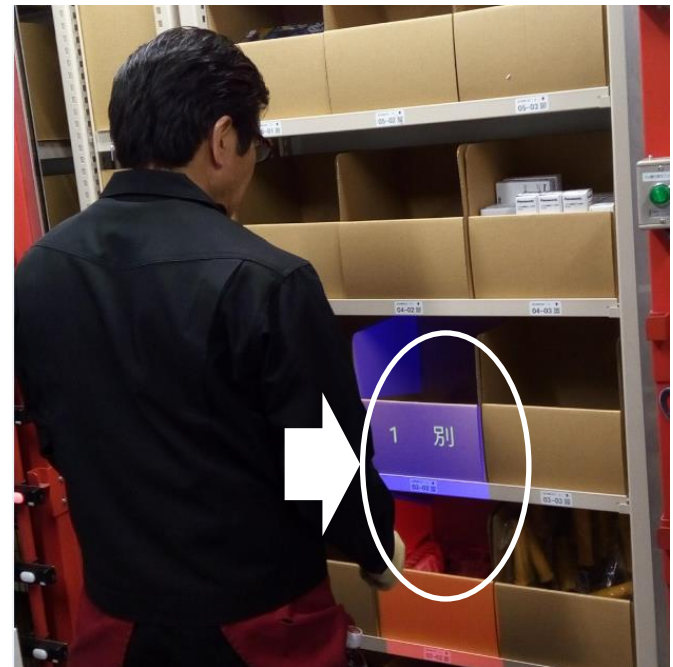
プロジェクションマッピング技術応用のピッキング
